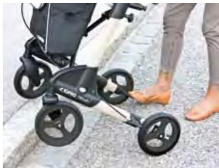
Die Ankipphilfe der Premiumrollatoren bietet dem Fuss eine breite Unterstützungsfläche beim Überwinden von Hindernissen. Der Rollator kann damit sicher über einen Bordstein o.ä. gefahren werden, beide Hände bleiben dabei am Rollator und bieten so Sicherheit.
